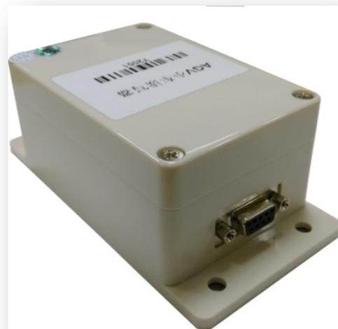
该工业级 RS485 总线读写器基支持 EPC C1 G2 /ISO 18000-6C 协议。
